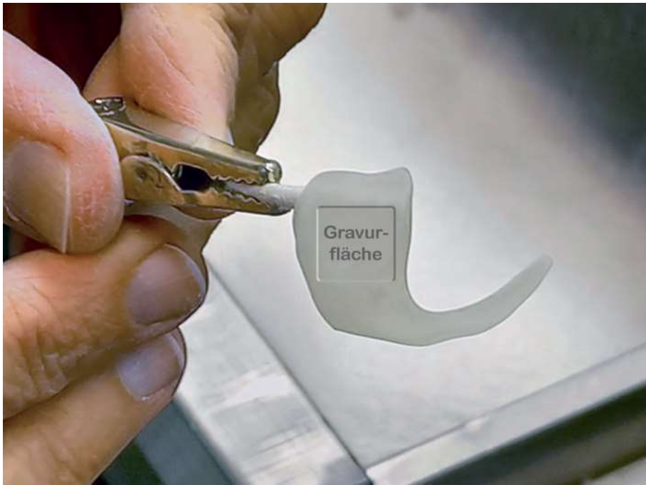
Mithilfe des 3D-Drucks lassen sich Informationen wie das Firmenlogo, eine Seriennummer oder der Name des Kunden auf der Otoplastik eingravieren.
